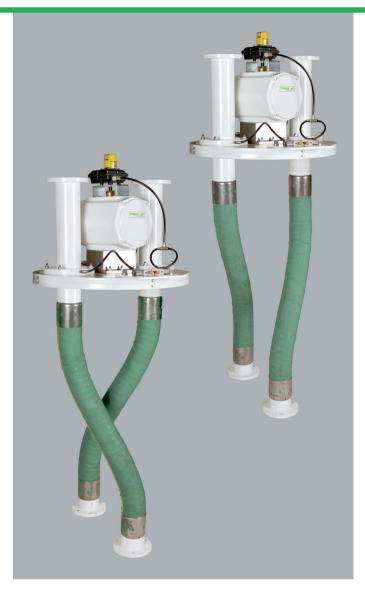
O uso do Crossover Switch da Dynamic Air é ideal sempre que dois sistemas de transporte pneumático precisam ser conectados para cruzar suas linhas de transporte, e assim alternar seus pontos de destino. Uma vez que transportes simultâneos podem ser realizados utilizando apenas um crossover switch, a rota da linha de transporte é simplificada, reduzindo o número de equipamentos necessários para esta tarefa.
