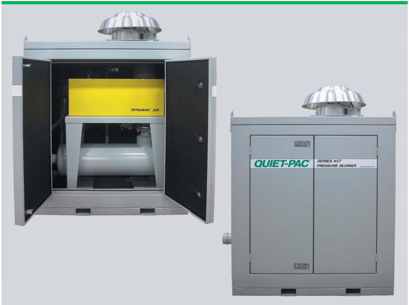
O Quiet-Pac conjunto de soprador da Série 457 Modelo 316 da Dynamic Air Inc. fornece uma solução definitiva na redução de ruídos, para 85 dBa ou menos. O soprador completo e o motor estão enclausurados em uma estrutura de atenuação acústica. Há quatro portas de acesso para a manutenção de todos os componentes. Um ventilador para resfriar também está incluso para maior proteção do motor longa duração. O
